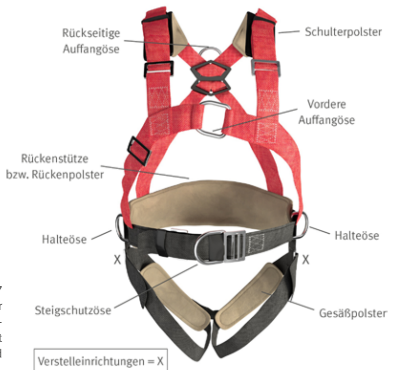
Abb. 27 Beispiel eines Auffanggurtes mit vorderer und rückseitiger Auffangöse, seitlichen Halteösen und einer Steigschutzöse. Der Gurt ist zusätzlich mit Schulter-, Bein- und Rückenpolstern ausgestattet.
